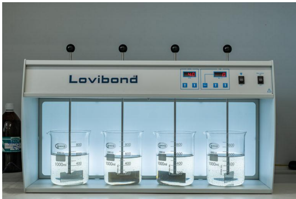
Jar-tester – simuliranje procesa na postrojenju za prečišćavanje voda
