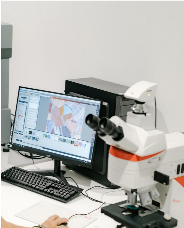
Metalografska ispitivanja – Leica DM4 sa uvećanjem do 2000x
