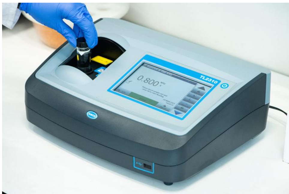
Turbidimetar – uređaj za određivanje mutnoće
