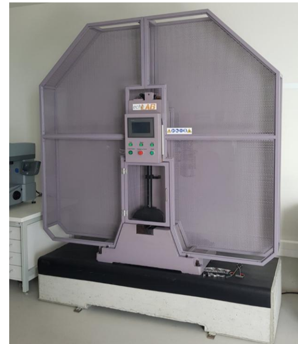
Ispitivanje udarne žilavosti metodom Šarpi
