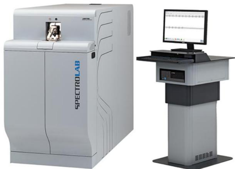
Ispitivanje hemijskog sastava metala metodom OES na najkvalitetnijem uređaju na svetu – spektrometar SpectroLab
